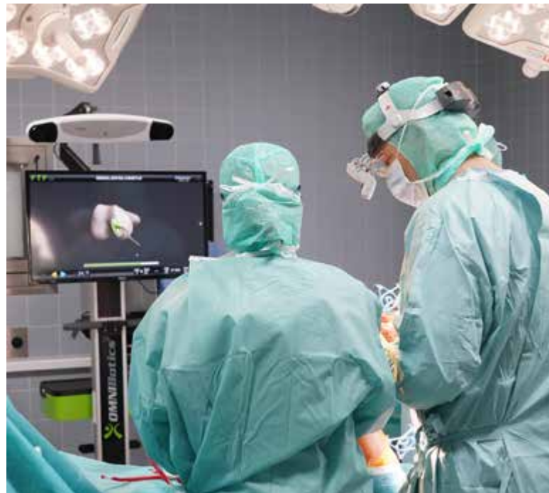
PD Dr. Heinrich Mühlhofer vermisst das Knie mit einem speziellen Infrarotpointer. Gleichzeitig erzeugt der Roboter die exakte Abbildung des Patientenknies als 3D-Modell.
