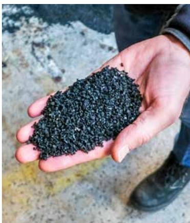
*Gummigranulat: Ausgangsmaterial für die Plattenherstellung*
