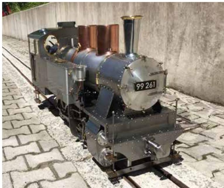
Dampflok LAG 64 in 7 1/4 Zoll im Maßstab 1:5. Gefertigt im Eigenbau durch die Firma Wimmer Maschinenbau aus Übersee
